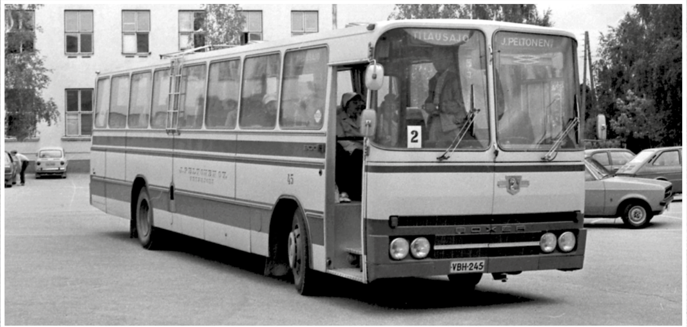
J Peltonen Oy osti tämän uutena v. 1973 ja auto sai kylkinumeron # 45. Alusta on Leyland PSU3B-2L, kori on tyylikäs Boxer 300. Tällä autolla ajettiin 1990-luvulle asti. Kuvauspaikkaa en muista.
