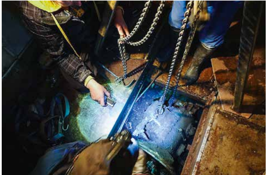
Vaihteisto on irrotettu ja voidaan nostaa auton matkustamoon huoltoluukun kautta.
