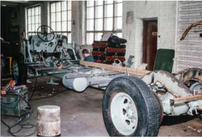
Rungon päälle hitsattiin poikittaiset nelikulmateräsputket, joiden varaan lattia perustettiin.
