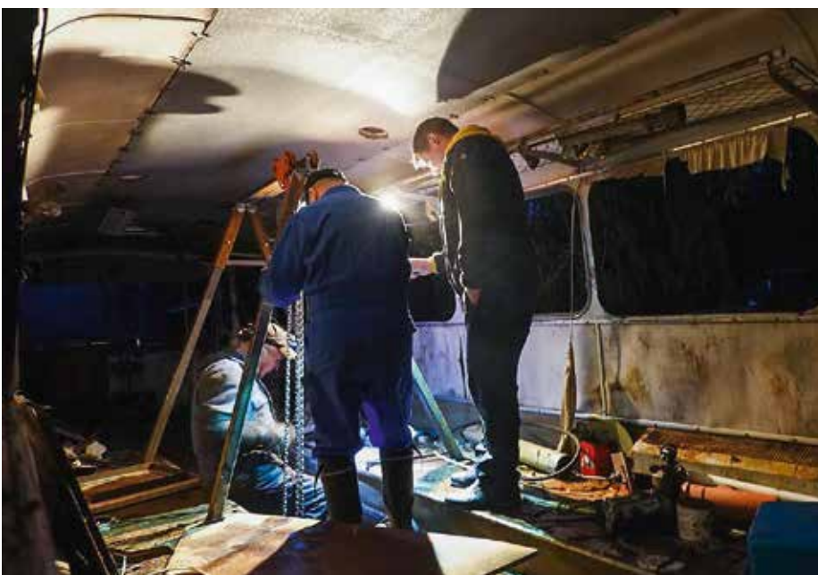
Vaihteisto on irrotettu ja voidaan nostaa auton matkustamoon huoltoluukun kautta.
