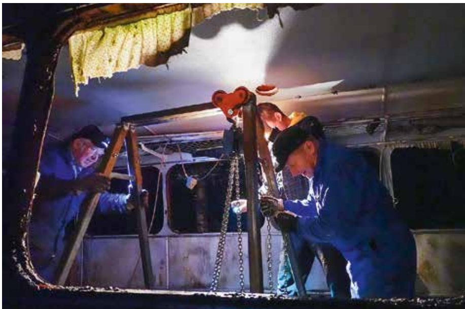
Vaihteisto on irrotettu ja voidaan nostaa auton matkustamoon huoltoluukun kautta.
