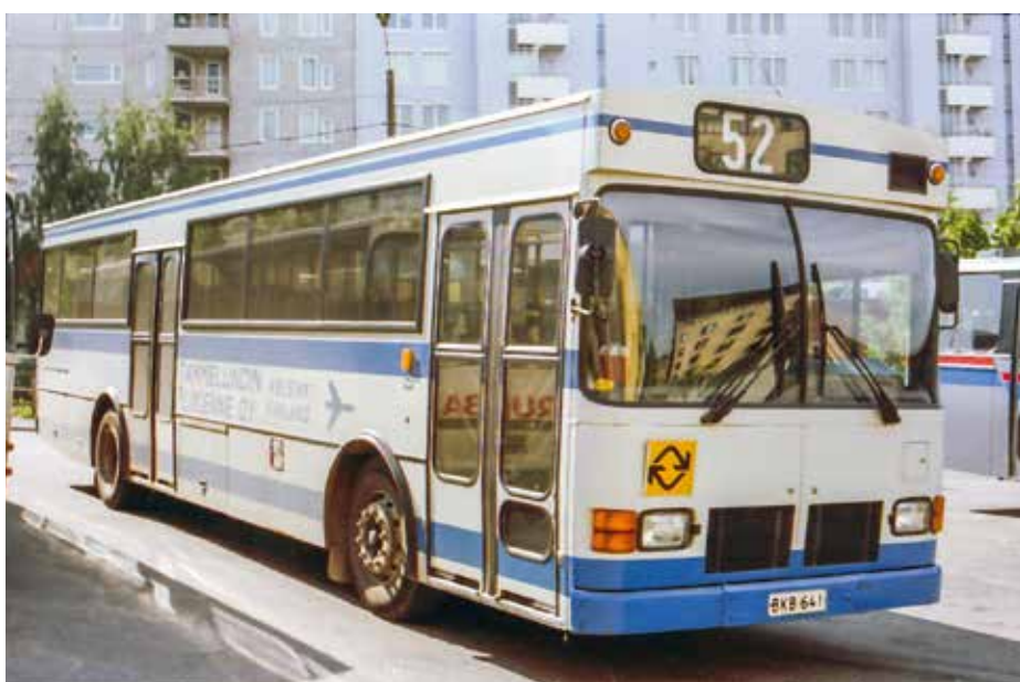
Viimeisimpiä Suomessa käyttöönotettuja Sisu linja-autoja oli Tammelundin Liikenteen auto nro. 1, joka rekisteröitiin liikenteeseen kesäkuussa 1988 rekisterinumerolla BKB-641 portugalilaisella Camo Lissabone -katurikorilla. Sisu BT-58 alusta varustettiin ennen koritusta Cummins-moottorilla. Kuva: SLHS kokoelmat/Pertti Ranta.
