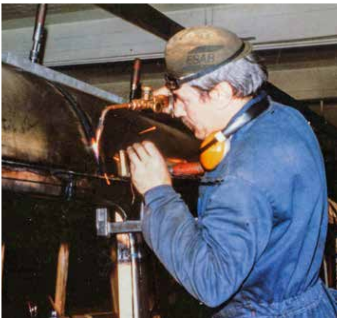
Juhani Laakso hitsaa kattopeltejä kaasuhitsauksella.
