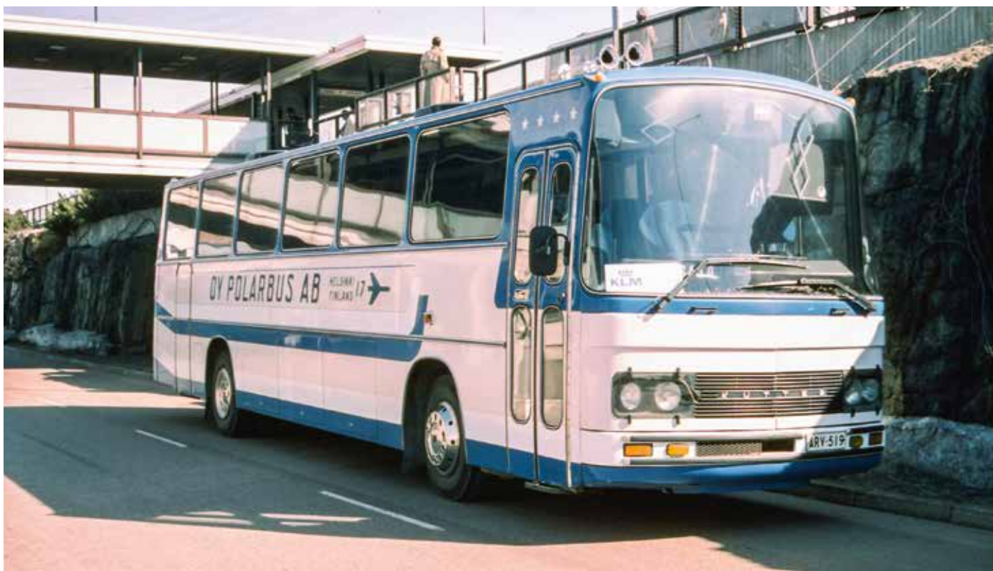
Tammelundin Liikenne -ryhmään kuuluneen Oy Polarbus Ab:n auto nro. 17, Sisu BT-58 alusta, johon asennettiin Mercedes-Benz V8 -moottori. Kori Kutter 9 SS, käyttöönotto maaliskuu 1983, rekisteritunnus ARV-519. Kuva: SLHS kokoelmat/Pentti-Olavi Salin.
