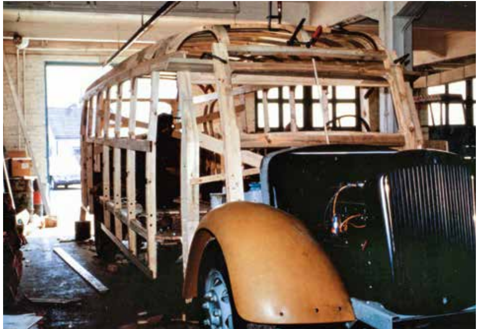
Korin pääpiirteet ovat jo näkyvissä pellittämättömässä korikehikossa.
