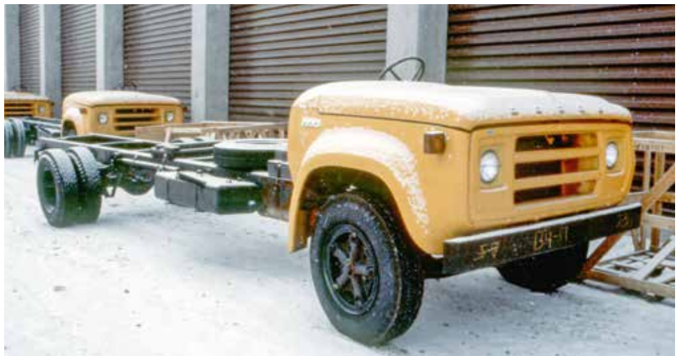
Chrysler-yhtymän USA:ssa valmistamat koululaiskuljetukseen tarkoitetut Dodge linja-autonalustat suomennettiin Sisu-akseleilla ja Valmet Linnavuoren tehtaan valmistamilla moottoreilla Postin Tampereen varikolla. Kuva: SLHS kokoelma/Olli Blomberg.
