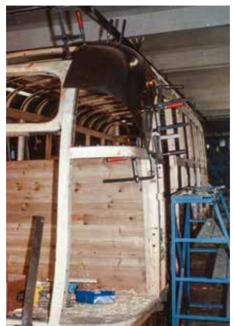
Ensimmäisten koripeltien muodot alkavat ahmottua korin katon takakulmissa.
