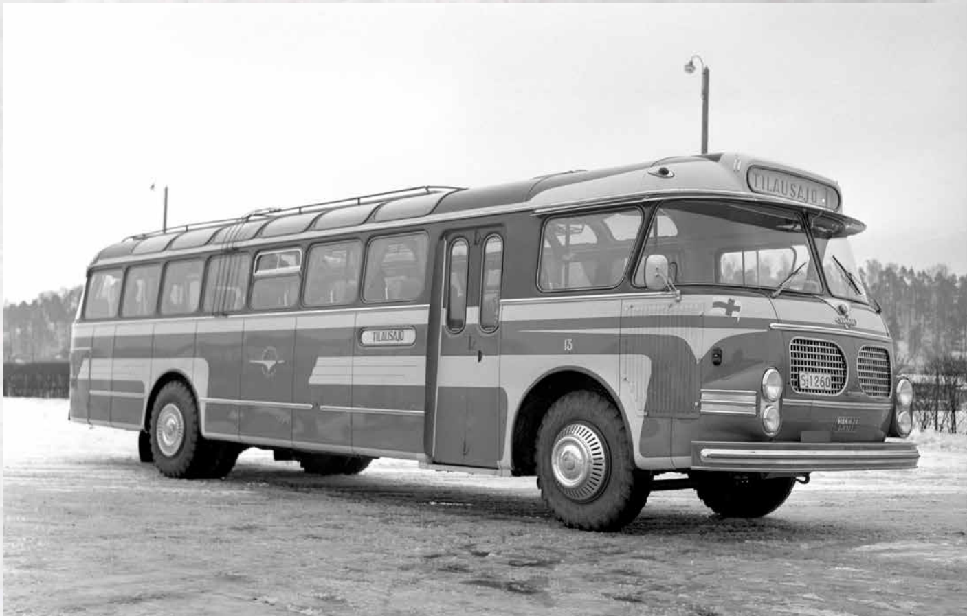
1950-luvun Nurmeksens Autoista ei pakinan kuvitukseksi löytynyt sopivaa kuvaa, mutta SLHS:n kuva-arkistosta löytyi kuva Nurmeksens Autolle vuonna 1960 toimitetusta autosta nro. 13 (rek.nro. SK-521), jossa oli Lahden Autokorin valmistama kori ja Vanaja alusta.
