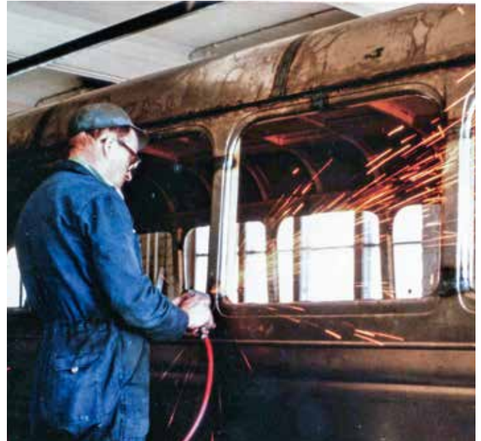
Aimo Lehtinen hioo ikkunan puitteiden pellityksessä syntyneitä hitsaussaumoja.
