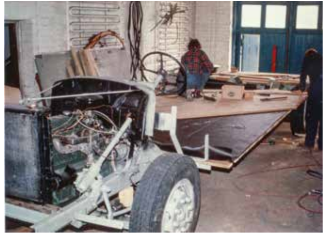
Toisessa lattiakerroksessa käytettiin vinolaudoitusta – laudoituskerrosten välissä tervahuopa.
