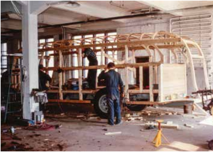
Korikehikon saatua muotonsa, rakennusaikaiset tuet voitiin poistaa.
