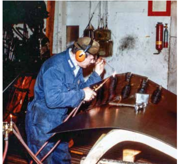
Juhani Laakso muotoilee koripeltiä käyttämällä kaasuhitsausta.
