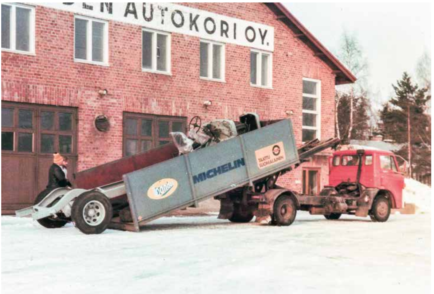
Ventun korjattu alusta saapui Villähteelle koritettavaksi vaihtolavakuorma-auton kyydissä.
