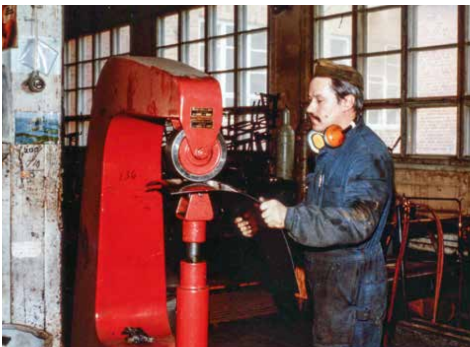
Juhani Laakso muotoilee peltiä peltimankelissa, jota myös kutsutaan "englanninpyöräksi".
