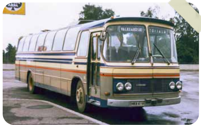
Valkeakosken Liikenne no. 16, rek. HKK-616, Leyland PSU3A-2L/Autokori Airisto, kov. 1971 (aikaisempi Someron Linja), oli totutusta liikenteestä poistuvia autoja. Kuva: SLHS kokoelmat/Tauno Hyytiä.
