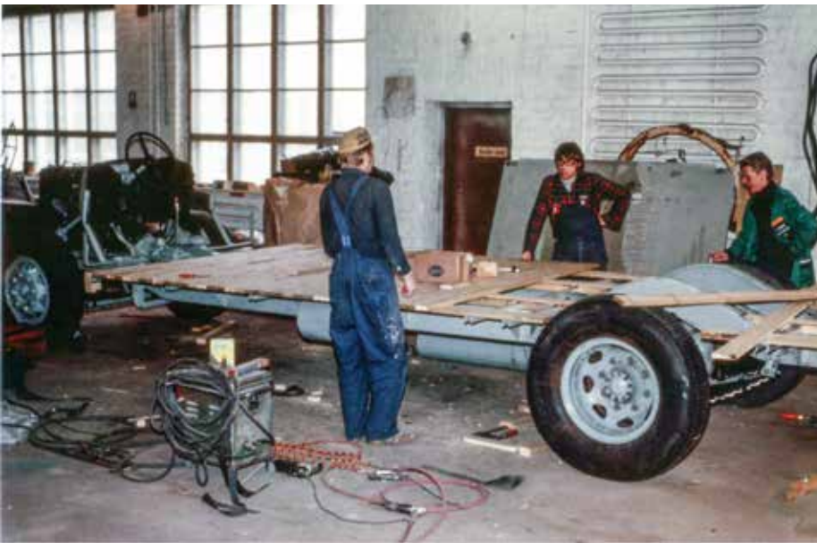
Lattian ensimmäisessä kerroksessa käytettiin pitkittäistukien päällä poikittaislaudoitusta.
