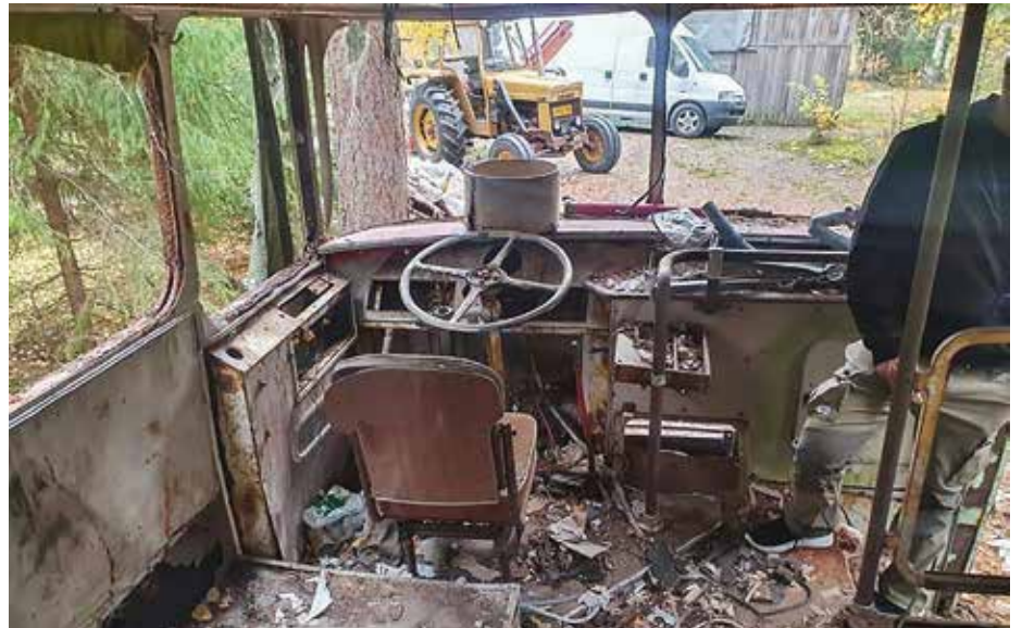
Leylandin ohjaamo syksyllä 2021, jossa erityisesti erottuu suurikehäinen nelipuolainen ohjauspyörä.
