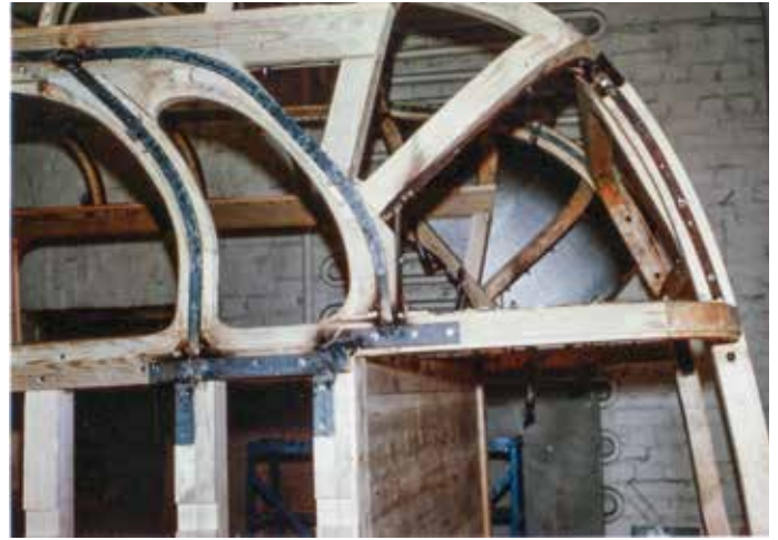
Puukoreissa jouduttiin pahimmin rasitetuissa kohdissa käyttämään raudoitusta vahvikkeena. Takasivukunassa Autokorin koreille tunnusomainen pisaramuoto.
