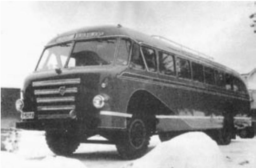
siihen piti rakentaa uusi etupää. Siitä tuli alkuperäistä kulmikkaampi sillä kaarevan tuulilasin saaminen oli ylivoimainen asia.
