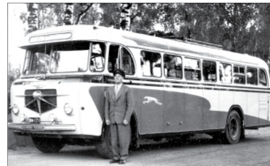
Kuvassa on O.Vilkas Oy:n Scania-Vabis B-5153V vuodelta 1955. Autossa oli Akron kori. Kuva: Tauno Hyytiän kokoelmat
