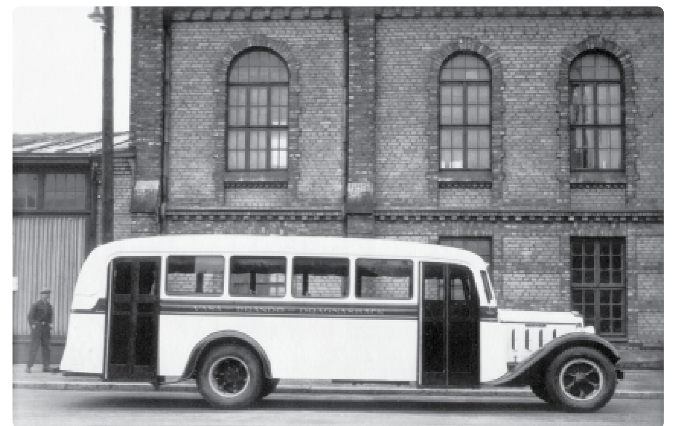
Valdemar Nordström liikennöi Vaasan paikallisliikenteessä vuosina 1925-1939. Kuvan 22-paikkainen Auto-korirakenne Oy:n korittama Federal tuli Palosaaren linjalle vuonna 1934. Viisi vuotta myöhemmin auto siirtyi yrityksen omistajanvaihdoksen myötä Valdemar Södermanin nimiin. Kuva: SLHS/Kutter-arkisto
