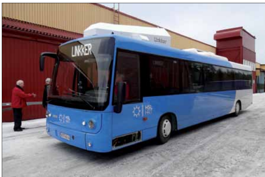
Uusien autojen paraati jatkui, kun pääsimme koeajolle Helsinkiin toimitettavalla Linkker-sähköbussilla. Vaikka auto perustuu kaupunki-Kabus-linja-autoon on keulaan haettu uutta ilmettä. Katolla oleva kotelo pitää sisällään virroitimen, jolla auto lataa itsensä päätöspysäkillä.
